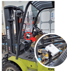
작업자, 지게차, 트랜스포터, 크레인 등 복합 위치 기반 충돌 예방 및 알림
